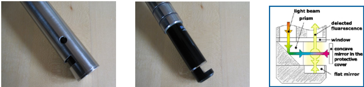
Abbildung 4: Die Sonde von Hellma: Der Sondenkopf besteht aus einem Quarzglaskörper in einem Edelmantel. Der Glaskörper sorgt für eine 90° Anordnung von Anregungs- und Detektionslicht (rechtes Bild).
