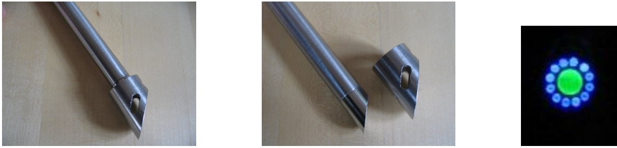
Abbildung 3: Die Sonde von Avantes: Links die Sonde mit Reflektor, in der Mitte der abgeschraubte Reflektor. Rechts ist die ringförmige Anordnung der Anregungsfasern um die Detektionsfaser zu sehen.
